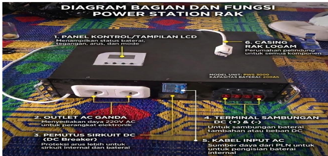
Gambar 1. Diagram Bagian dan Fungsi Power Stasion
